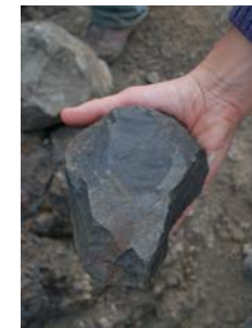
Schwerer Hammerstein zum Freilegen der Hämatitadern und Zerkleinern der Hämatitbrocken von der Mine San Ramón 15.
